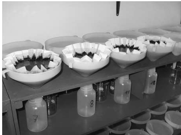
Abbildung 1: Im VKS-Aufbaukurs Qualitäten von Gärgut und Komposten wird die Qualitätsbestimmung auf den Anlagen geübt, hier die Extraktion für chemische Analysen
