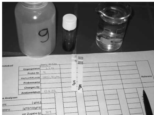
Abbildung 2: VKS-Aufbaukurs: Die Bestimmung von Nitrit und Nitrat aus dem Extrakt, die chemischen Analysen werden mit möglichst einfachen Mitteln, aber dennoch in einer genügenden Genauigkeit durchgeführt.
