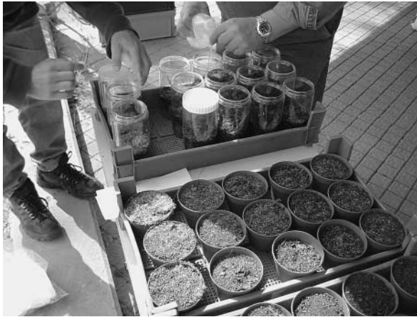
Abbildung 3: VKS-Aufbaukurs: Neben den chemischen Analysen interessiert die Pflanzenverträglichkeit. In jeweils 3 Töpfen werden die gleichen Pflanzensaat wiederholt, um eine stabilere Aussage zu erhalten.
